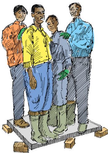
Figure 6. Quatre hommes testent la solidité d'une dalle de latrine
